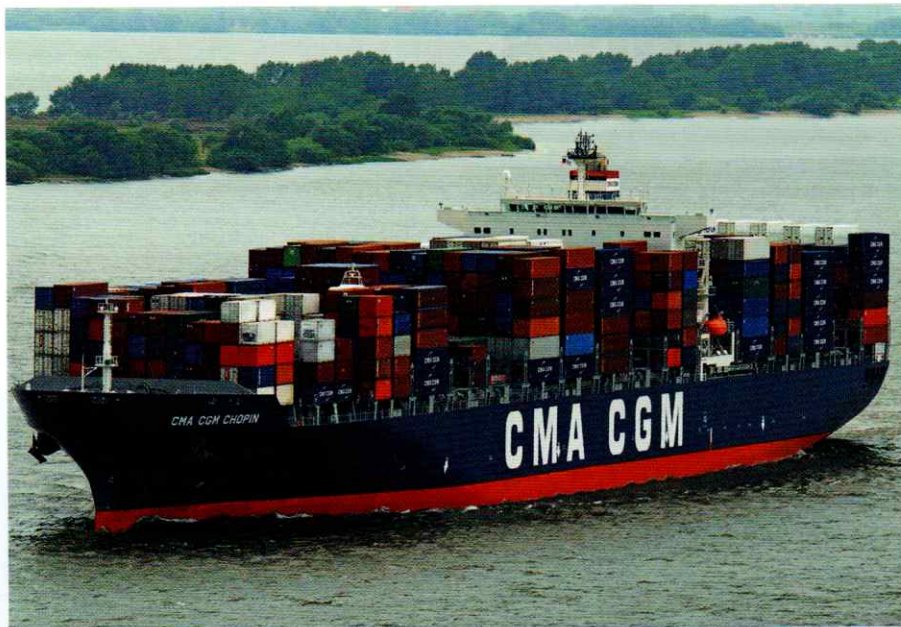
Le porte-conteneurs Chopin est un navire de 277 m de long et 40 m de large qui peut transporter 8 000 conteneurs. Il suit la route maritime Barcelone-Fos-sur-Mer-Gênes-Malte-Damiette (Égypte)-Canal de Suez-Port Kelang (Malaisie)-Chiwan Qingdao (Chine)-Pusan (Corée du Sud) en effectuant 6 escales.
